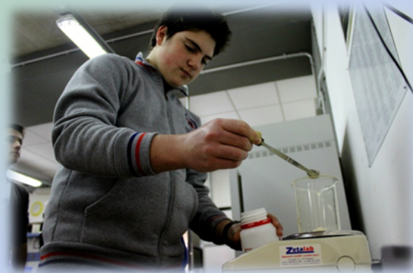
Pesatura, con bilancia analitica, dei diversi componenti previsti dal protocollo specifico.
